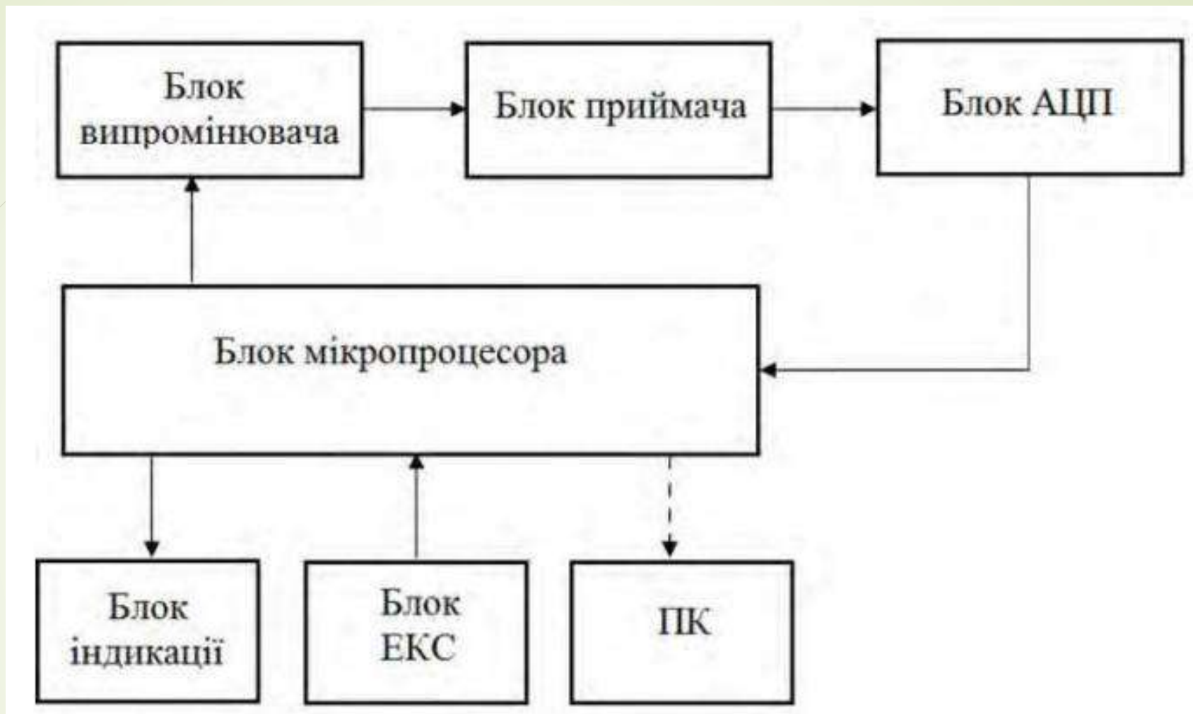
Структурна схема автоматизованого фотоплетизмографа
