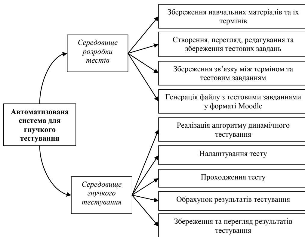
Рис. 3. Функціональна схема автоматизованої системи для гнучкого тестування
