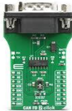
Рисунок 2.16 – Вигляд мережевого вузла CAN-FD Transceiver
