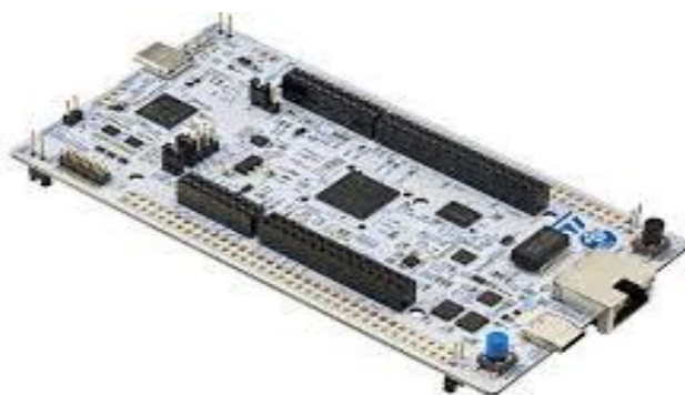
Рисунок 2.13 – Вигляд контролера ARM Cortex-M7 (STM32H7)
