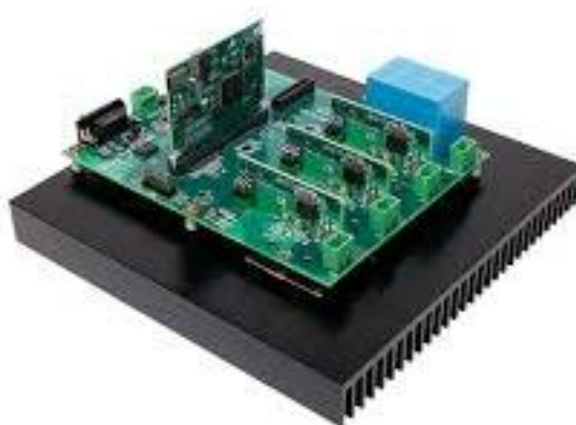
Рисунок 2.8 – Плата керування інвертора
