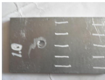
Рисунок 3.23 - Зразок для вимірювання шорсткості
