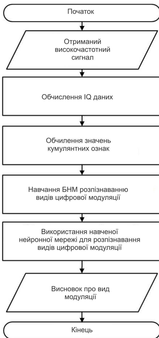
Рисунок 3.3. Блок-схема алгоритму розпізнавання видів цифрової модуляції при відомому значенні носійної частоти
