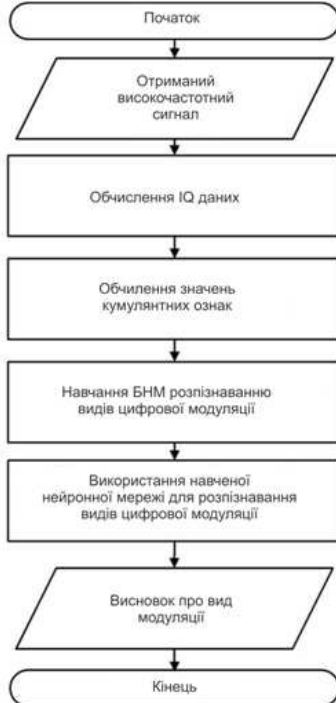
Рисунок 18.1. Блок-схема алгоритму розпізнавання видів цифрової модуляції при відомому значенні носійної частоти
