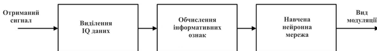
Рисунок 1.10. Система автоматичного розпізнавання видів цифрової модуляції
