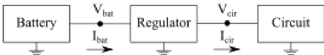
Рисунок 2.16 – Принципова схема роботи стабілізатора напруги
