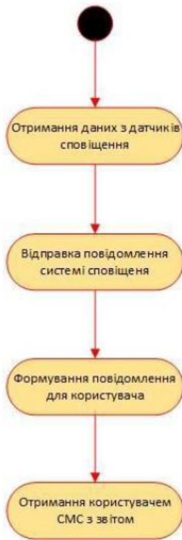
Рисунок 3.6 – Алгоритм роботи сповіщення користувача
