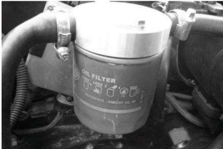
Рисунок 1.10 – Гравітаційний масляний фільтр
