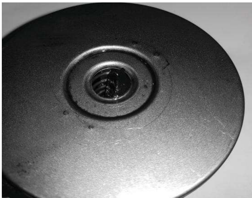
Рисунок 2.2 – Поломка перепускного клапана внаслідок недостатньої жорсткості утримуючої пружини
