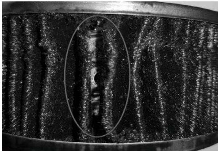
Рисунок 2.1 – Розрив фільтруючого паперу
