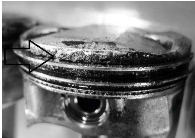
Рисунок 1.6 – Освіта нагару на поршневих кільцях
