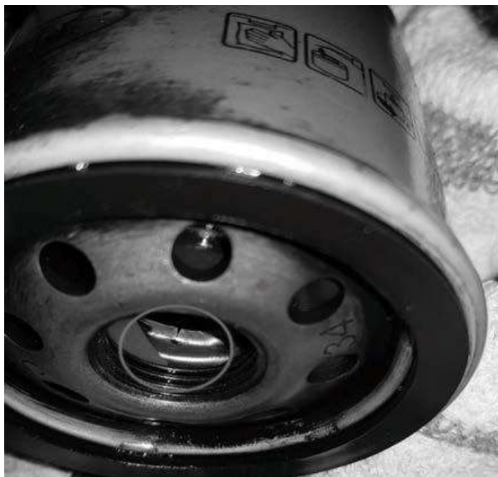
Рисунок 2.3 – Фільтр «Geely sk» із пошкодженням дренажного клапана
