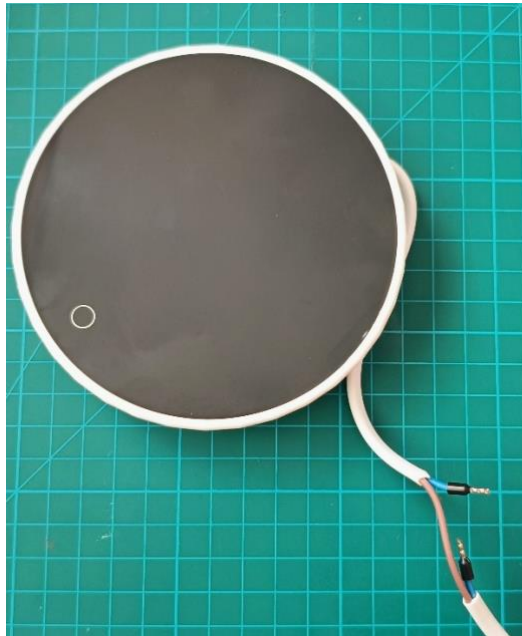
Рисунок 3.2 – Зображення розрізу проводу підставки для подальшого підключення до реле
