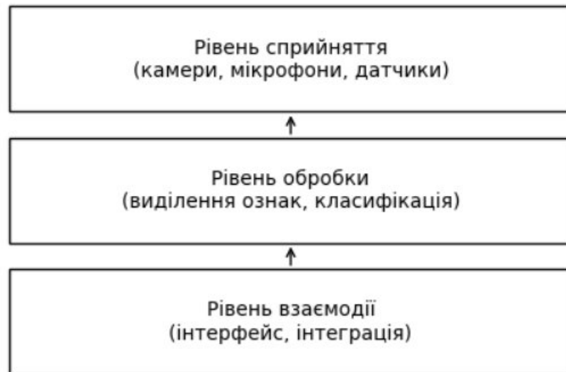
Рисунок 2.1 – Структурна схема кіберфізичної системи визначення емоційного стану людини за комп'ютером
