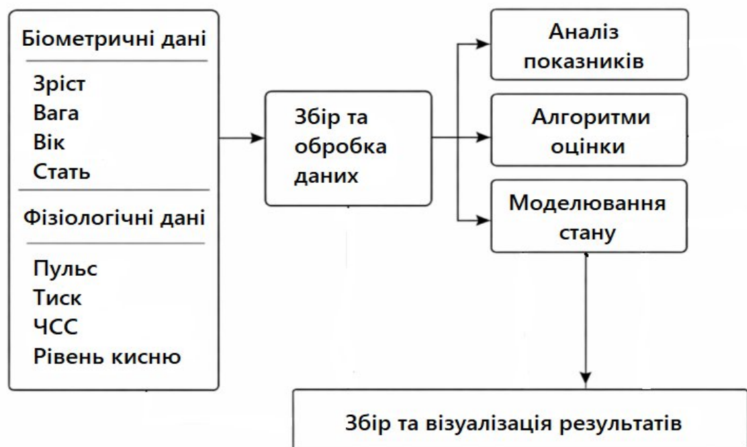
Рисунок 2.6 – Структурна модель аналізу біометричних та фізіологічних показників
