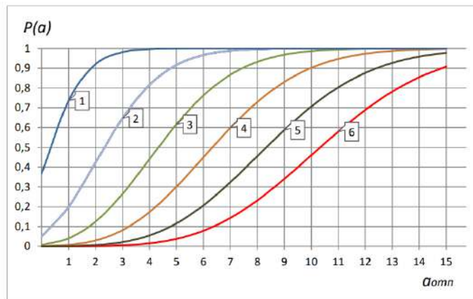
Рисунок 16 – Залежність ступенів покриття P(a) від середньомовірного числа ударів ворсинки в площу, що дорівнює площі власного відбитка: 1, 2, 3, 4, 5, 6 – ступінь покриття відповідно 1, 2, 3, 4, 5, 6 разів
