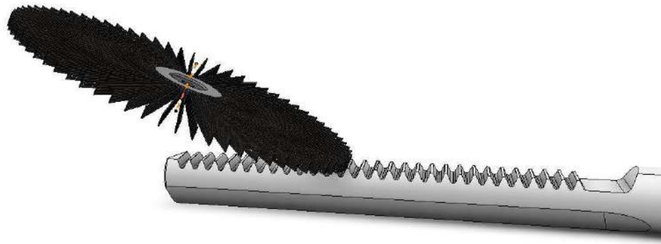
Рисунок 12 – Обробка гнучким інструментом ізометрії
