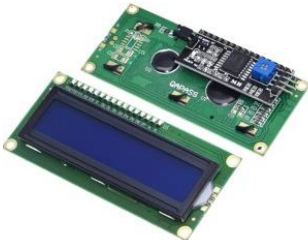
Рисунок 2.5 – Символьний модуль LCD 1602 [48]
