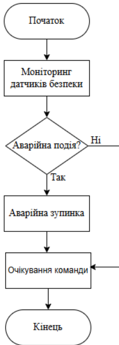
Рисунок 3.4 – Блок-схема роботи SafetySupervisor
