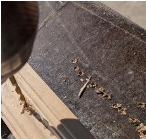
а – висвердлювання отворів на рамах; б – протягування ниток основи
