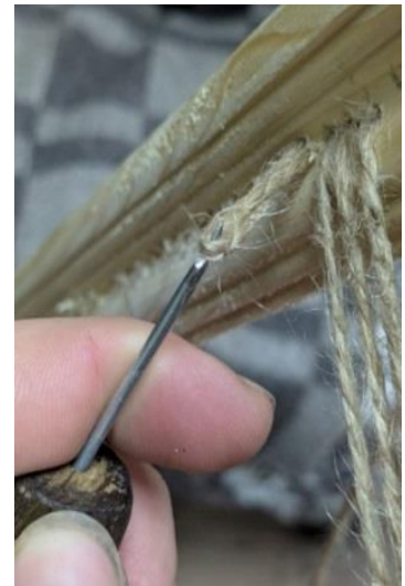
а – висвердлювання отворів на рамах; б – протягування ниток основи
