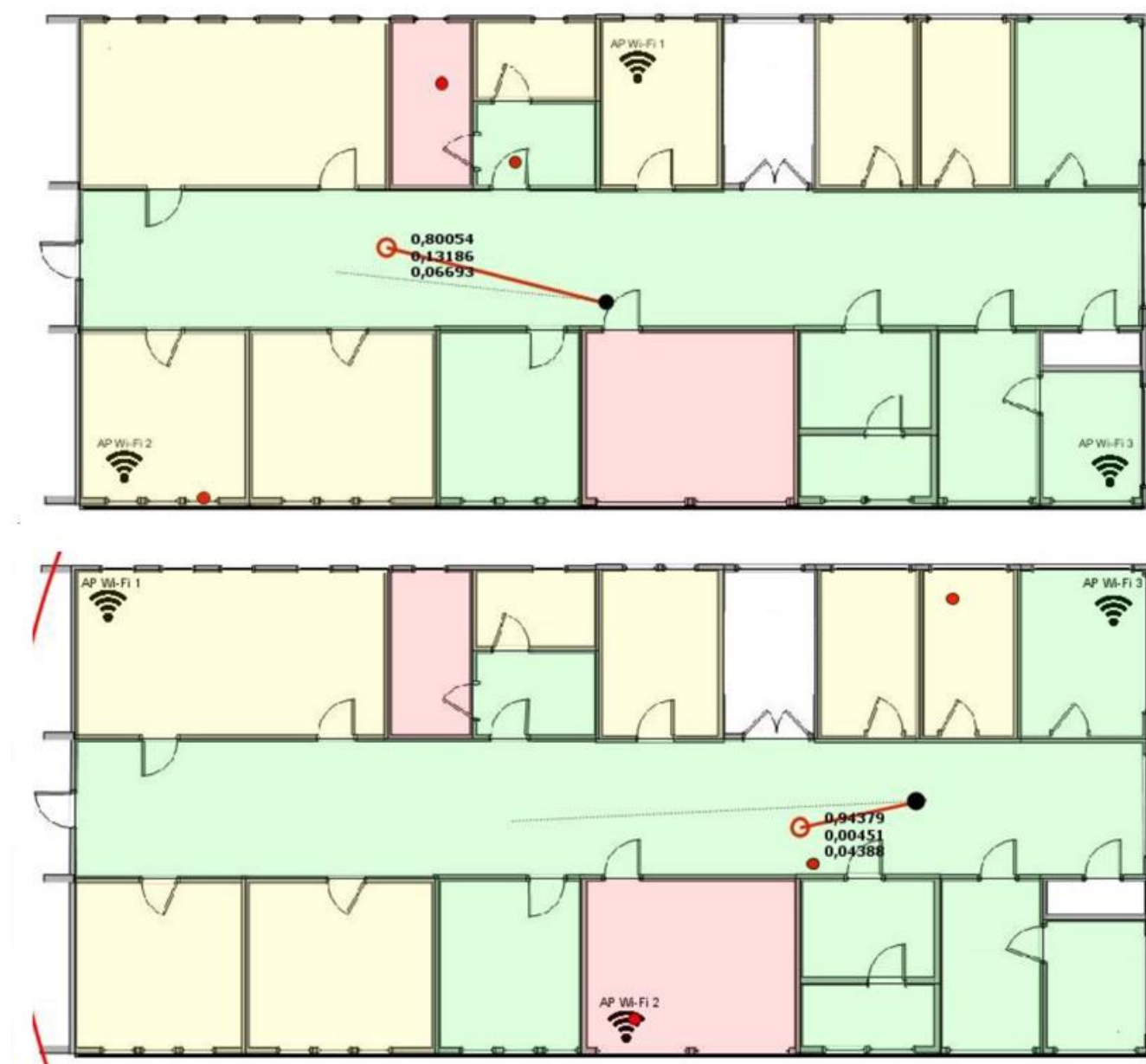
Рисунок 4.6 – Схема оптимального розташування трьох точок доступу на досліджуваній схемі поверху з точки зору мінімальної помилки визначення місця розташування
