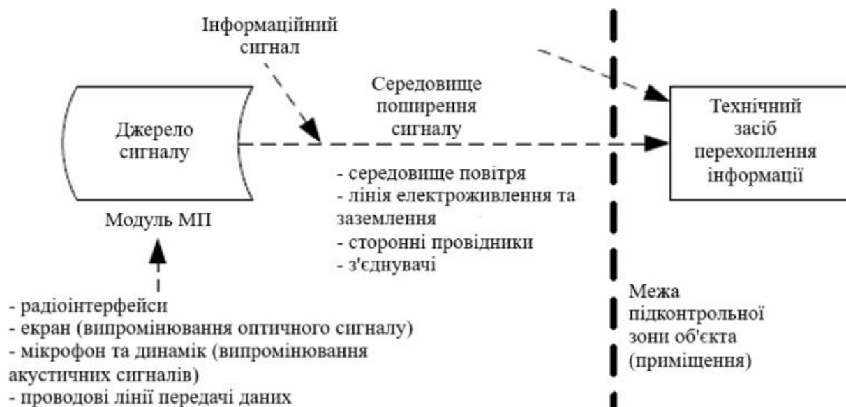
Рисунок 1.7 – Схема технічного каналу витоку інформації, що обробляється засобами обчислювальної техніки
