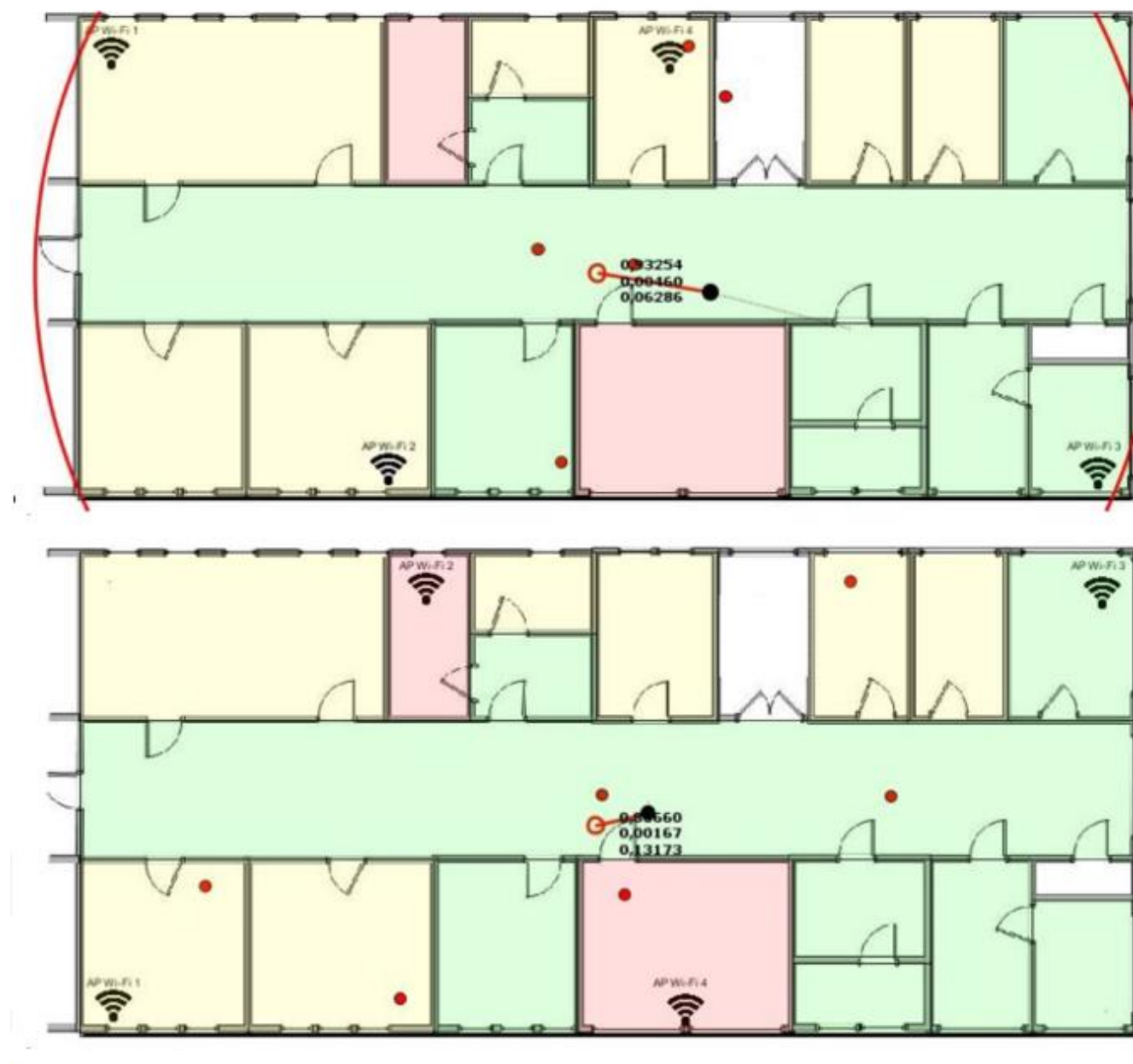
Рисунок 4.7 – Схема оптимального розташування чотирьох точок доступу на досліджуваній схемі поверху з точки зору мінімальної помилки визначення місця розташування
