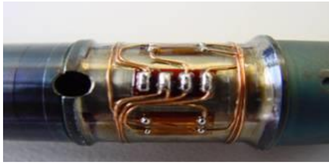
Рисунок 3.5 – Тензодатчик наклеєний на циліндричну поверхню
