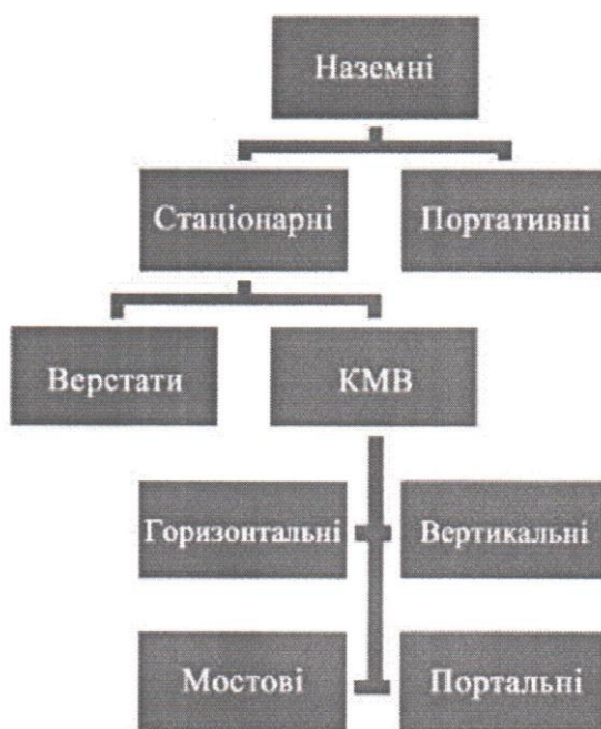
Рисунок 1.10 - Класифікація наземних 3D сканерів за способом встановлення сканера [12]
