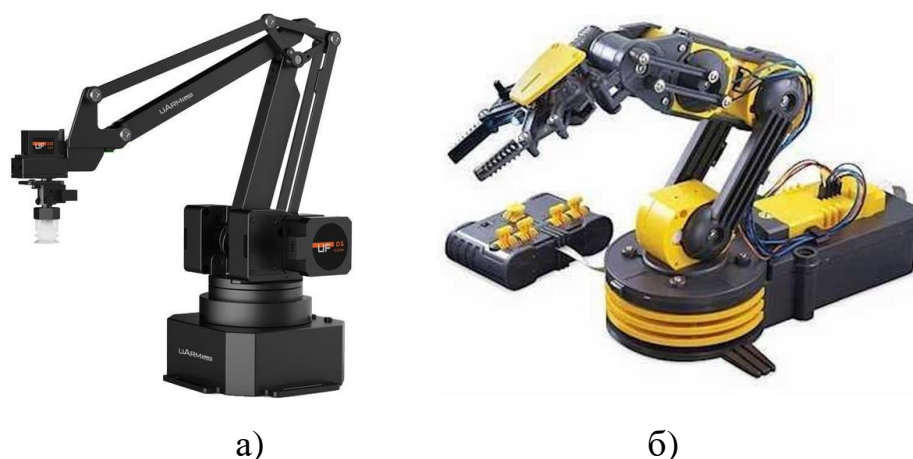
а - модель uArm Swift Pro; б - модель OWI Robotic Arm Edge Рисунок 1.5 – Сучасні навчальні та дослідницькі маніпулятори
