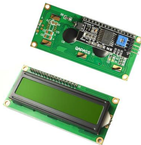
Рисунок 2.13 – LCD-дисплей з підключеним інтерфейсним модулем І 2 С для вибору режиму та відображення параметрів роботи робота
