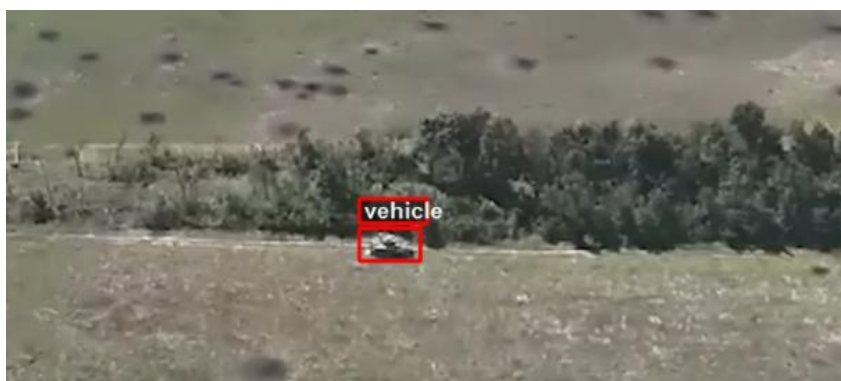
Рисунок 3.14 – Виявлення транспортного засобу за умов часткового маскування рослинністю
