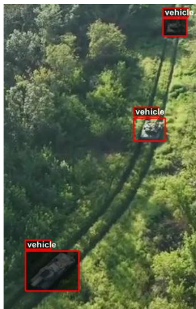
Рисунок 3.7 – Виявлення та візуалізація об'єктів у системі розпізнавання в реальному часі
