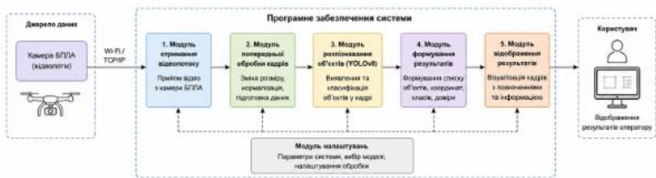
Рисунок 3.2 – Структура програмних модулів системи розпізнавання об’єктів
