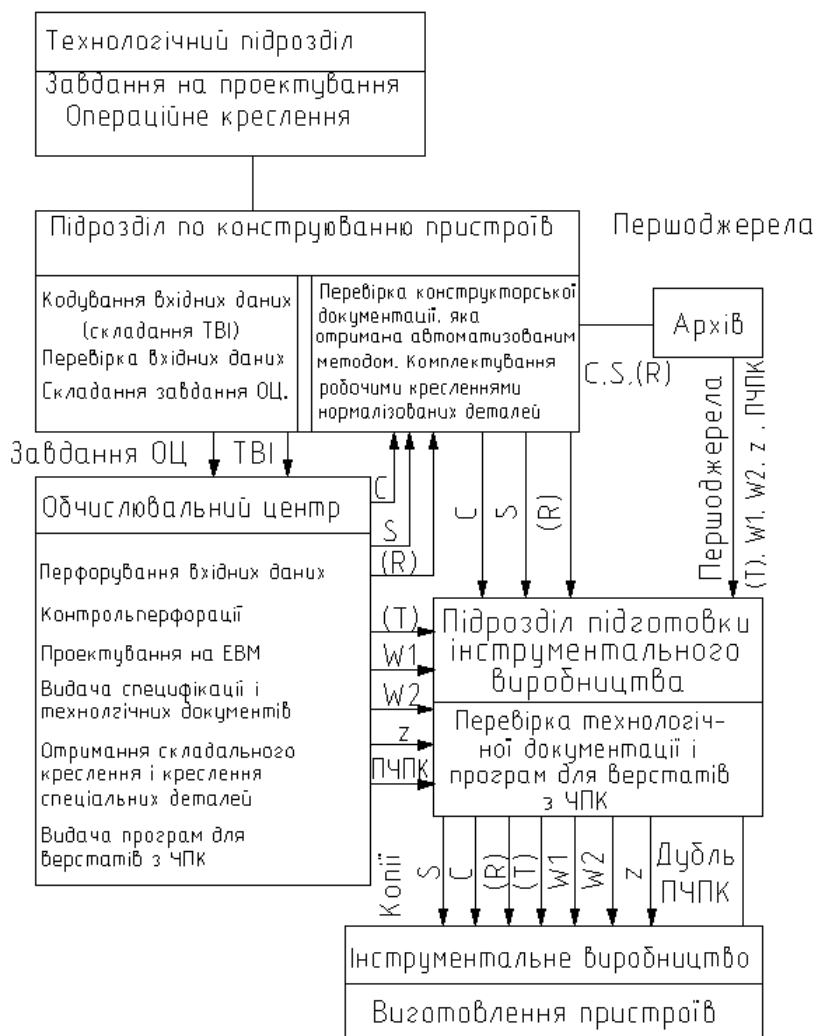
Рисунок 1.1 - Технологічна схема організації автоматизованого проектування верстатних пристроїв на промисловому підприємстві
