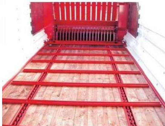
Рисунок 2.5- Причепи з активізацією розвантаження зіштовхувального типу з ланцюговим приводом.
