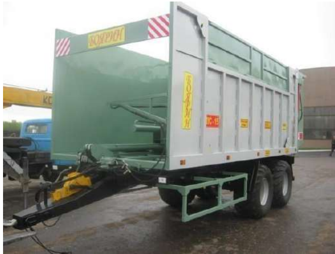
Рисунок 2.4 - Причепи з активізацією розвантаження зіштовхувального типу з гідравлічним приводом
