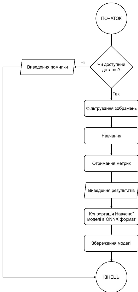
Рисунок 2.2 – Схема алгоритму навчання нейромережі
