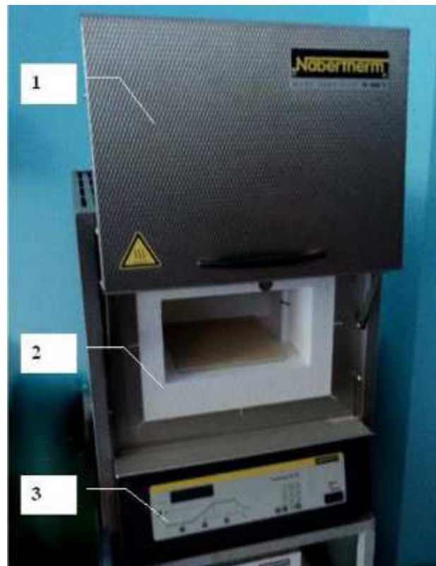
Рисунок 2.8 – Зовнішній вигляд та пристрій муфельної печі LT5/12/B170 компанії Nabertherm з блоком управління процесом B170: 1 – двері печі; 2 – муфель для завантаження зразків; 3 – блок управління процесом B170
