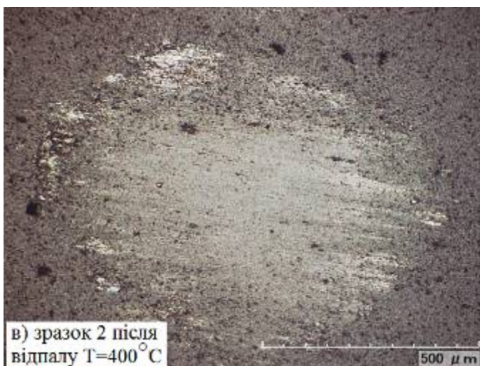
Рисунок 3.6 – Сліди тертя алюмінієвого контртіла після 1200 обертів на поверхні покриття С:W до відпалу (а) і після відпалу (б), а також на поверхні покриття С після відпалу при температурі 400^{\circ}\text{C}
