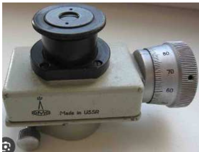
Рисунок 2.7 – Зовнішній вигляд мікрометра МОВ-1-16х
