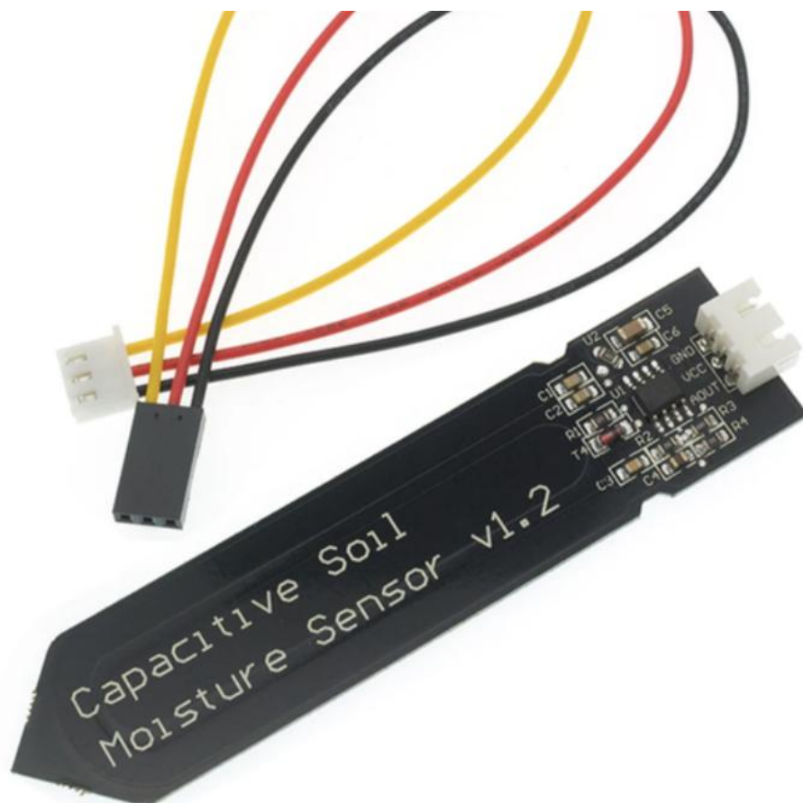
Рисунок 1.5 – Ємнісний давач вимірювання вологості ґрунту
