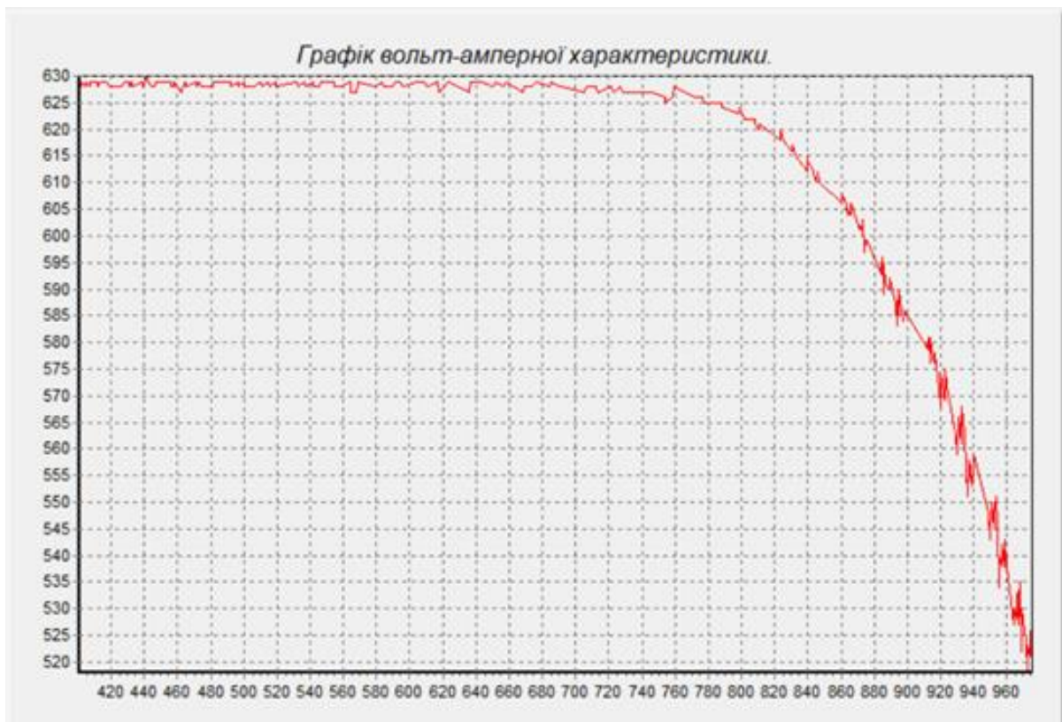
Рисунок 3.17 ВАХ ФЕМ, після очищення поверхні.
