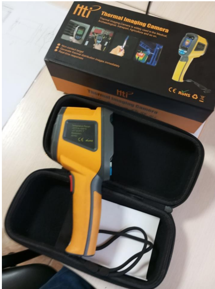
Рисунок 3.12 Тепловізор НТІ НТ-02, що був використаний для теловізійного контролю елементів пристрою.
