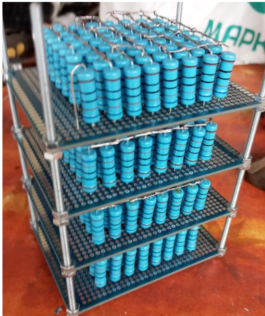
Рисунок 3.8 Матриця резисторів навантаження (з'єднувальні провідники відсутні).
