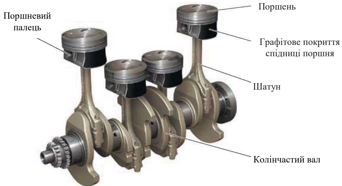
Рис.10 – Кривошипно-шатунний механізм
