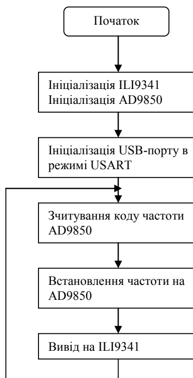
Рис. 6. Алгоритм роботи генератора
