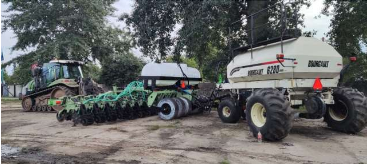
Рис.3.1. Комплекс для внесення рідких добрив
