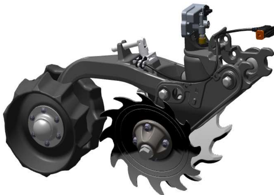
vApplyHD – Модуль контролю і регулювання рідкого продукту
