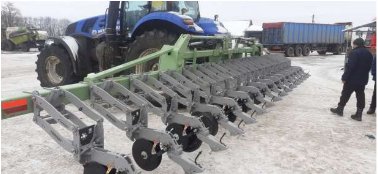
Рис.3.2. Висівні секції Harvest International LASERPRO 1
