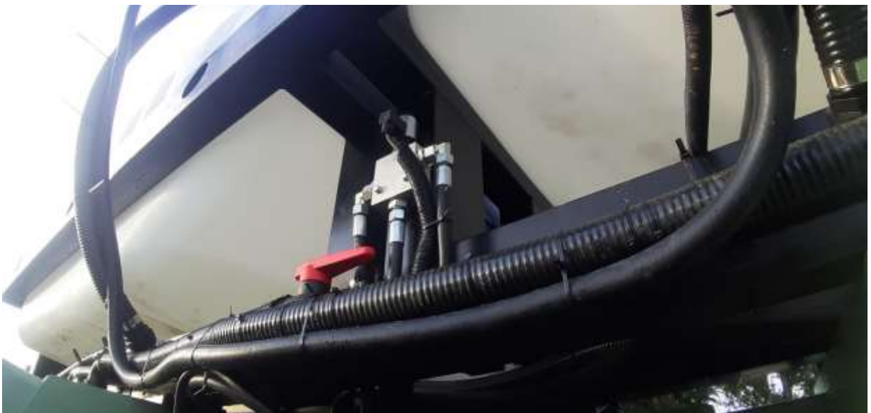
Рис.4.5. Мембранно-поршневий насос з гідромотором та ШИМ керуванням
