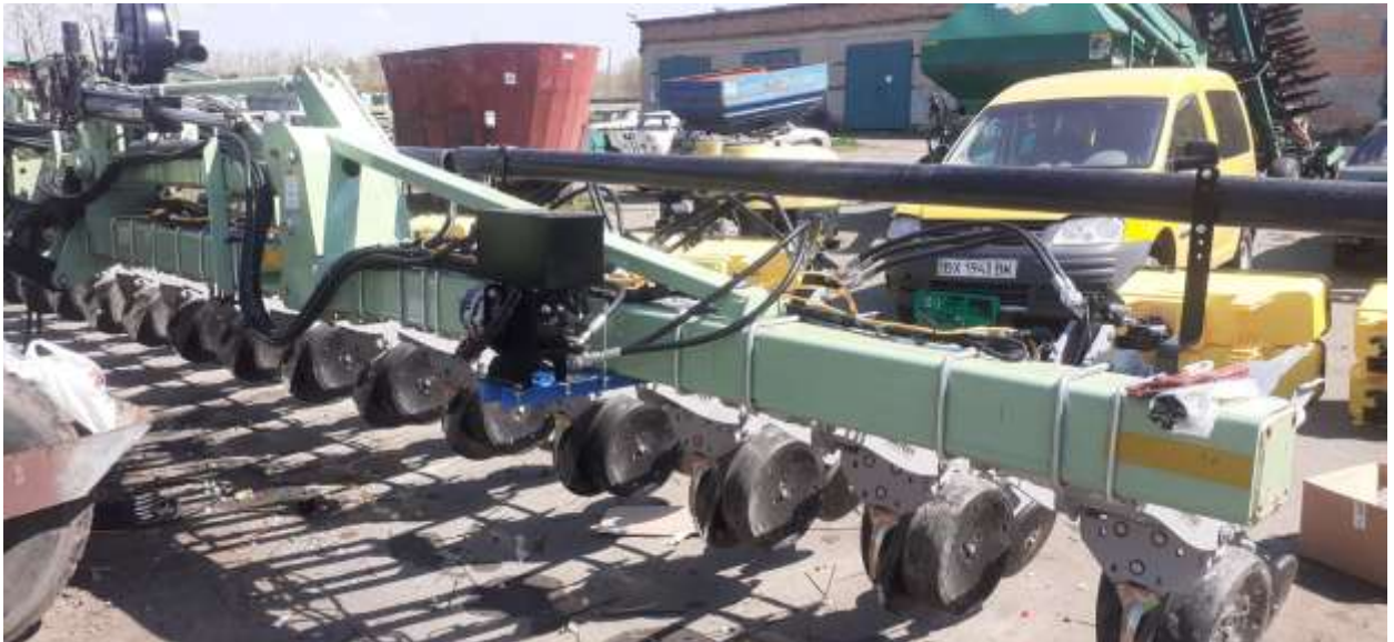
Рис.4.7. Додатковий генератор з гідроприводом на брусі з висівними секціями
