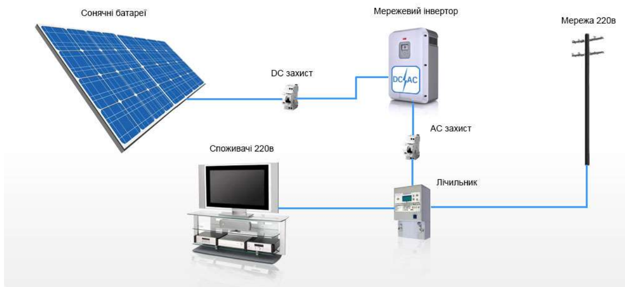
Рис. 3.3. Схема підключення сонячної батареї до споживача та електромережі
