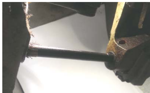
Рис. 3. Вигляд забруднення валу
