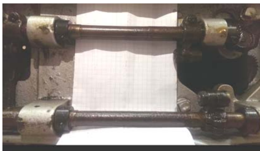
Рис. 2. Вали із забрудненнями у вузлах ковзання
