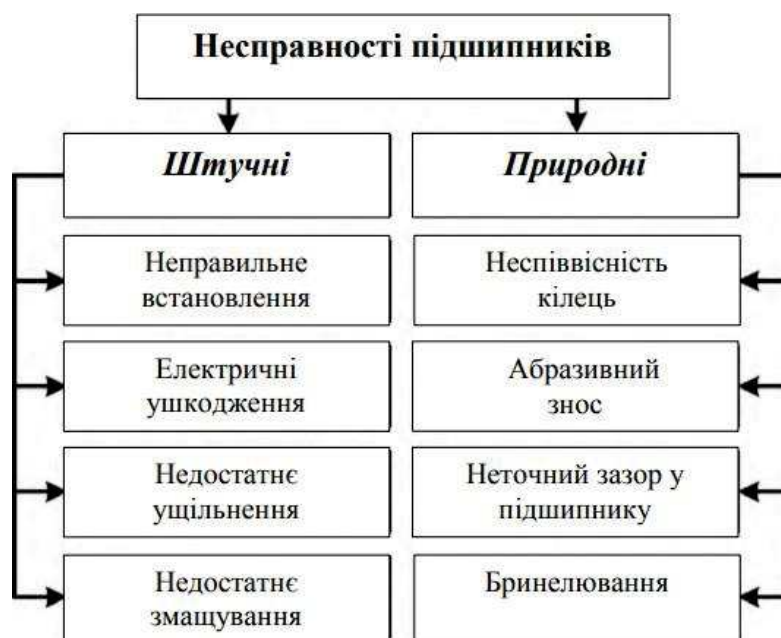
Рисунок 1.1 - Основні несправності підшипників [3]
