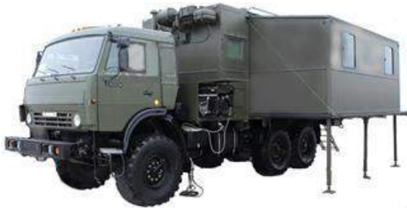
Рисунок 1.3 – ШМ на шасі КамАЗ 43118 з кузовом-контейнером змінного об'єму [3]
