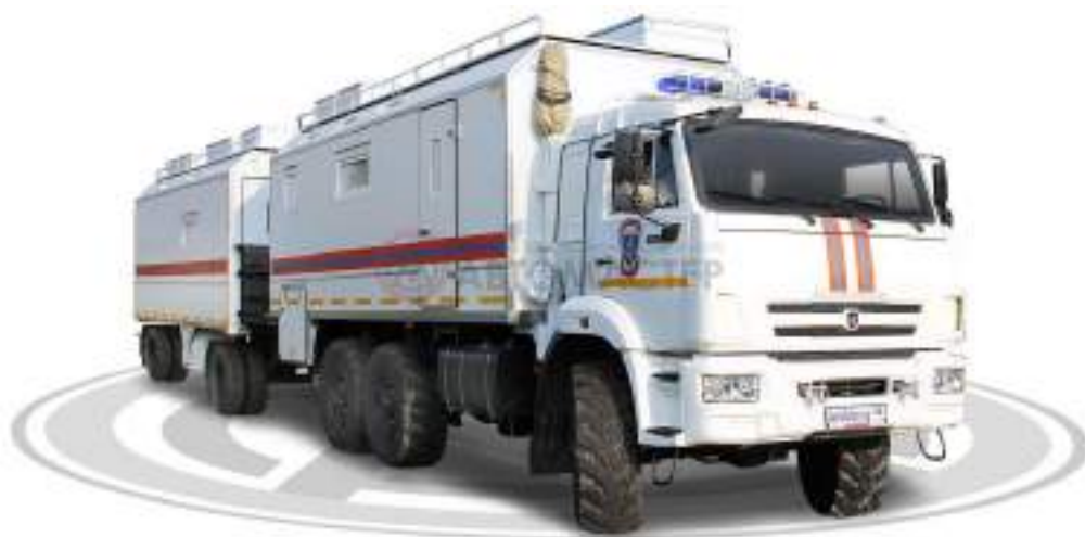
Рисунок 1.1 – Командно-штабний комплекс на шасі КамАЗ-43118
