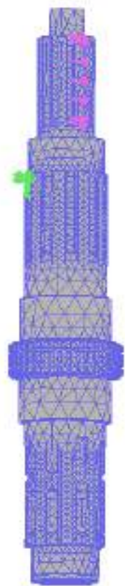
Рисунок 4.7 – Методика розділення 3D-моделі веденого валу на СЕ
