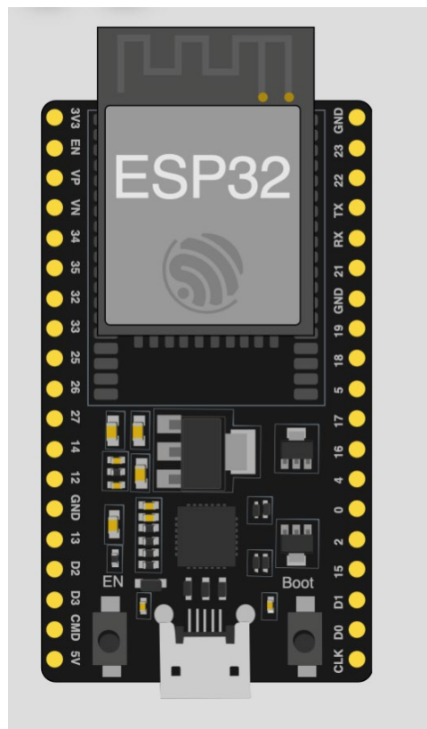
Рисунок 2.1 – Зовнішній вигляд та структурне розташування виводів плати розробника ESP32
