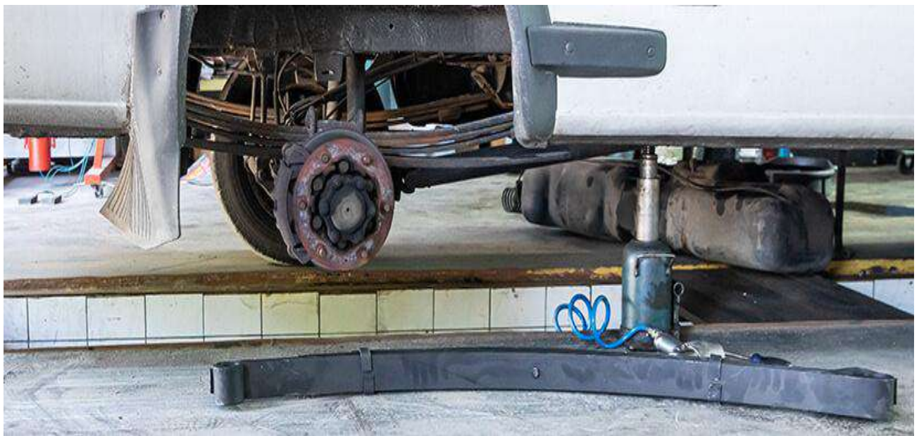
Рисунок 3.2 – Задня ресорна підвіска Sprinter
