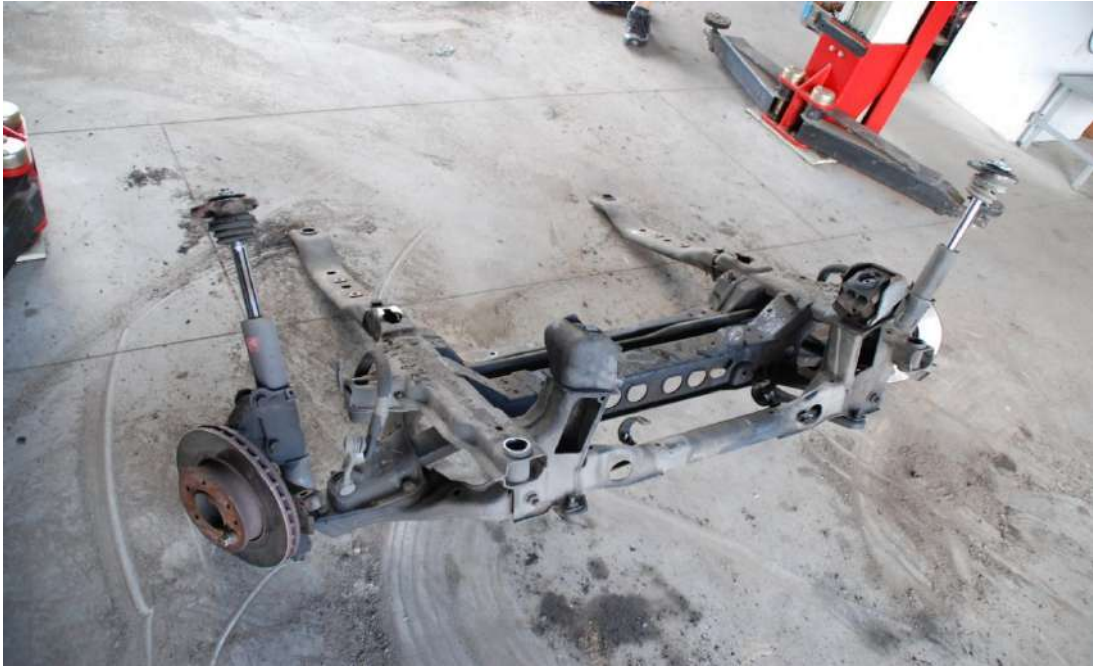
Рисунок 3.1 – Конструкція передньої підвіски Mercedes-Benz Sprinter
