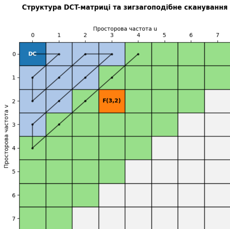
Рисунок 2.2 – Структура DCT-матриці та зигзагоподібне сканування з виділенням цільового коефіцієнта
