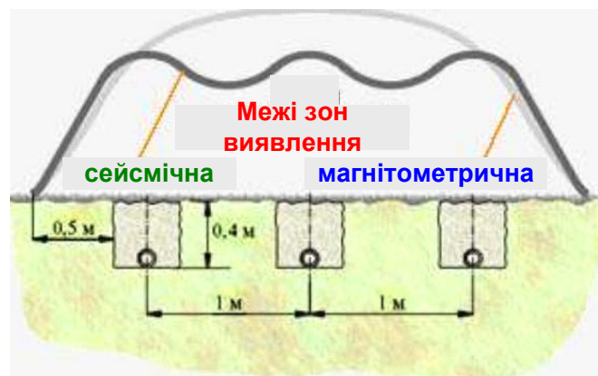
Рисунок 1.15 – Зони розташування розподілених елементів охоронної системи у ґрунті та зони виявлення порушників у вертикальній площині
