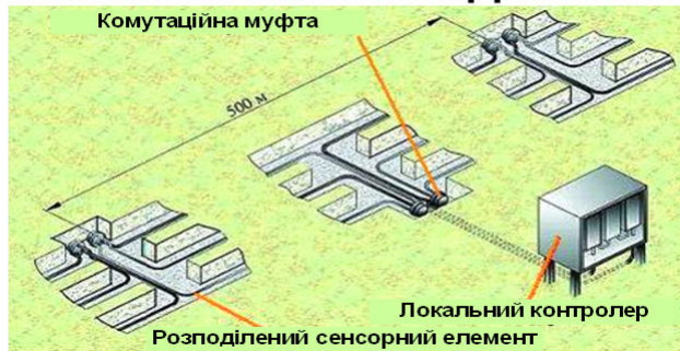
Рисуюнок 1 – Схема розташування елементів магнітодетектора системи охорони
