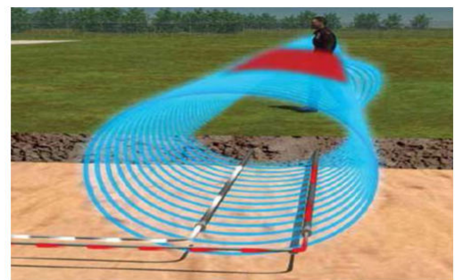
Рисуюнок 4 – Зони виявлення за допомогою розподілених магнітних сенсорів
