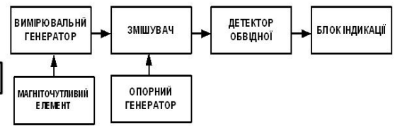
Рисуюнок 3 – Структурна схема резонансного частотного металодетектора (метод биття частот)
