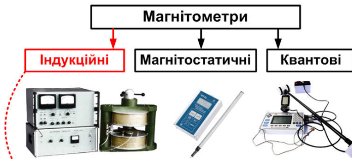
Рисуюнок 1 – Класифікація магнітометрів за принципом перетворення
