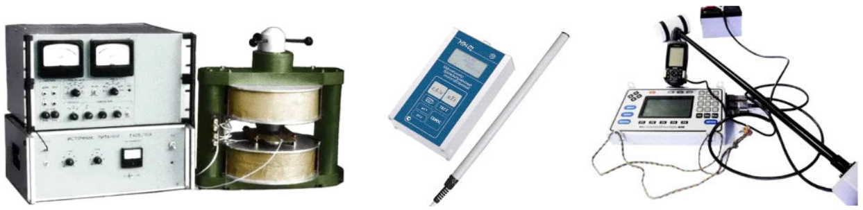
Рисунок 1.7 – Приклади конструкцій магнітостатичних, індукційних та квантових магнітометрів (зліва направо)
