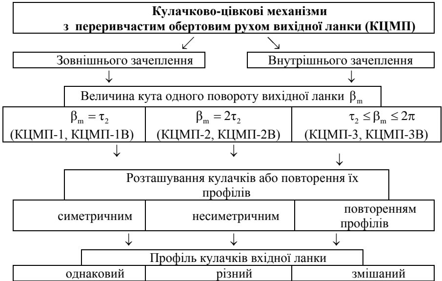
Рис. 2.1. Класифікація розроблених кулачково-цівкових механізмів з переривчастим обертовим рухом вихідної ланки
