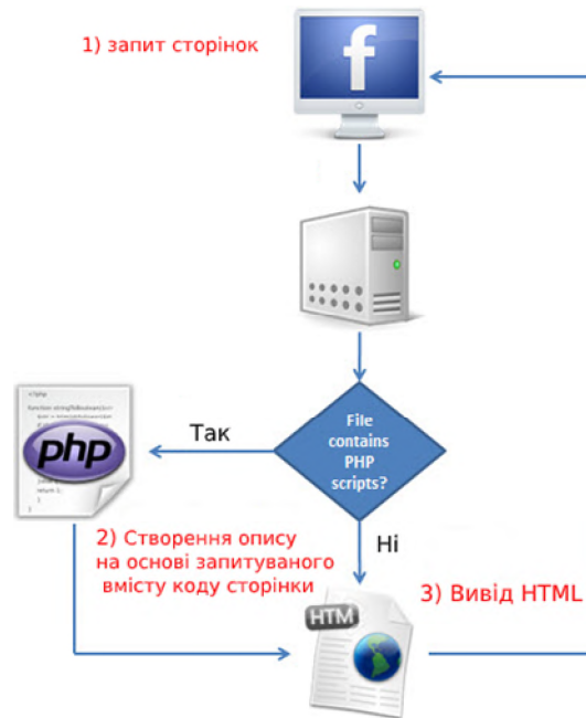
Рисунок 4.1 – Схема архітектури веб-програми PHP
