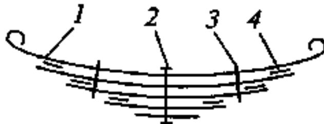
Рисунок 2.1 – Схема ресорної підвіски
