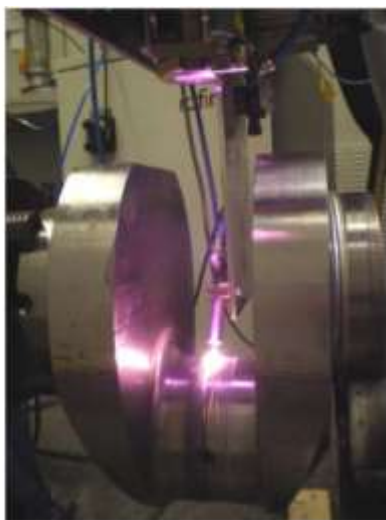
Рис. 2.18. Представлено процес лазерного наплавлення сегмента колінчастого вала.
