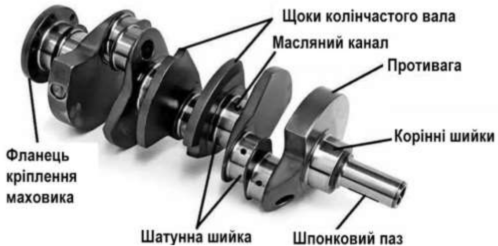
Рис. 1.1. Компоненти колінчастого валу.
