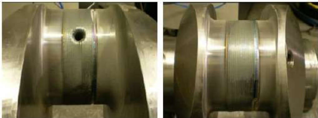
Рис. 2.20. Представлено лазерне наплавлення сегмента колінчастого вала навколо масляного отвору (зліва) та на нижній стороні у положенні нижньої мертвої точки (справа).
