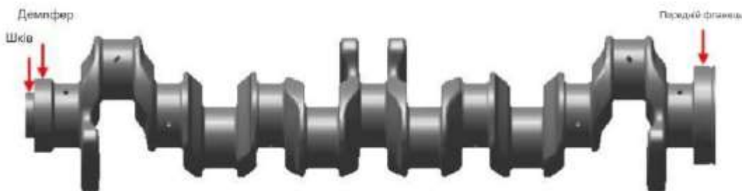
Рис. 1.5. Затверджені методи відновлення поверхні колінчастого вала через напилувальне зварювання та гальванічне покриття
