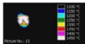
Рис. 2.13. Дані процесу зварювання одиночного шву на рівному зразку, який має незмінну зону розплаву і варіюється за потужністю лазера (зображено на лівій стороні), а також відповідний типовий розподіл температур (на правій стороні).
