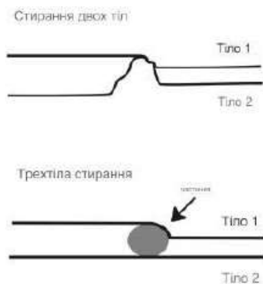
Рис. 1.2. Графічне зображення абразивного зношування за участю двох і трьох тіл
