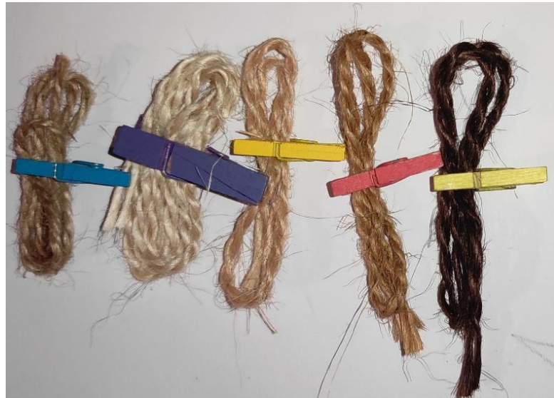
Рисунок 2.1 – Результати фарбування джгутового шпагату різними способами
