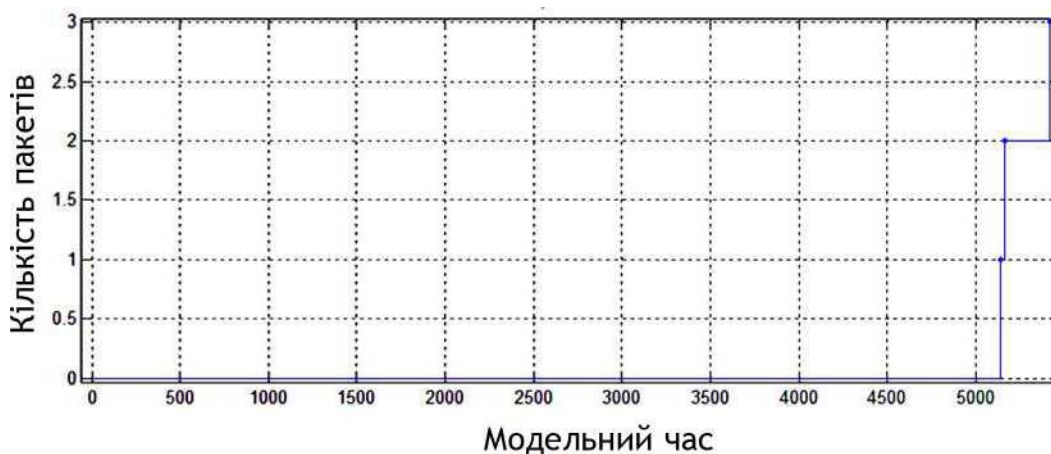
Рисунок 4.4 - Кількість утрачених пакетів потоку даних в буфері їх віртуального маршрутизатору при впливі її системи управління
