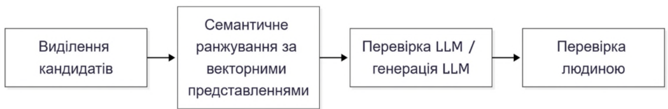
Рисунок 1.4 – Гібридна pipeline-архітектура сучасних систем трасування на основі великих мовних моделей
