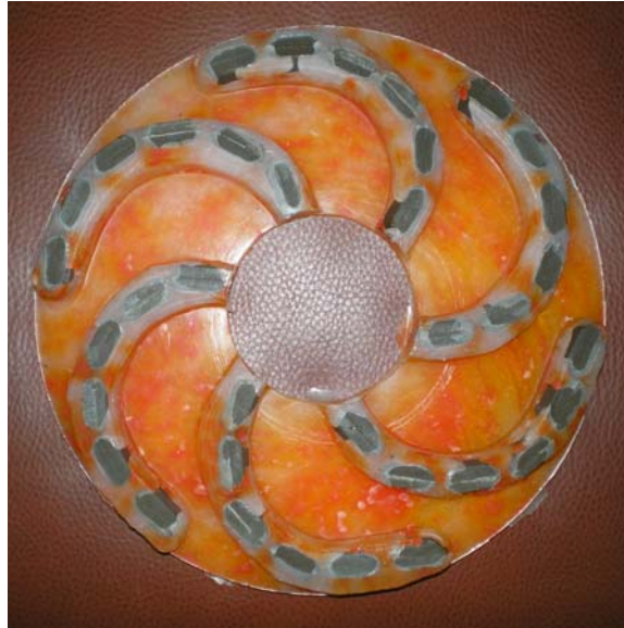
Рис. 4. Конструкція шліфувальної головки в реальному вигляді
