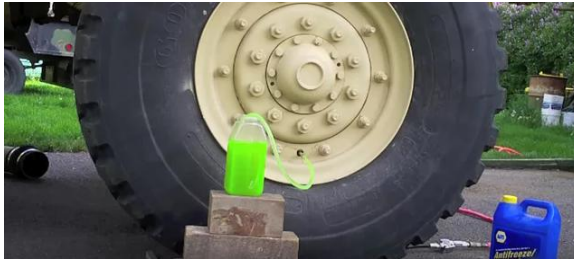
Рис. 3. Рідинне балансування коліс великих вантажних автомобілей
