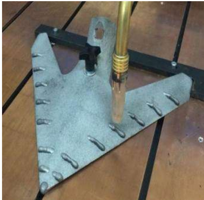
Рис. 2.14. Форма валиків при наплавлені лап культиваторів
