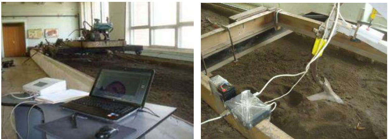
Рис. 3.9. Засоби вимірювання витрат на тертя культиваторних лап в ґрунтовому каналі
