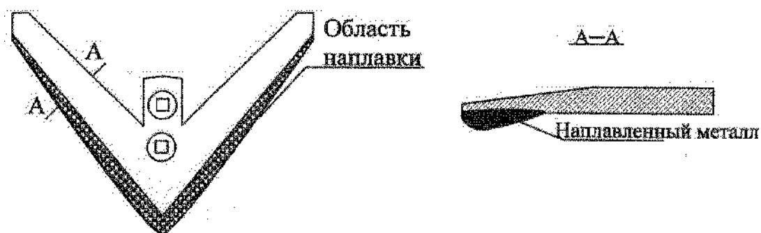
Рис. 2.9. Зміцнення електромеханічною обробкою лап культиватора з тильного боку лека
