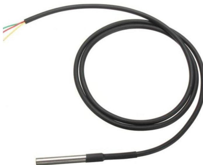
Рисунок 2.3 – Сенсор температури DS18B20
