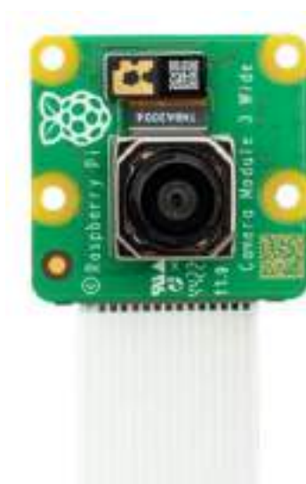
Рисунок 1.16– Зовнішній вигляд камери Raspberry Pi Camera Module 3 [38]
