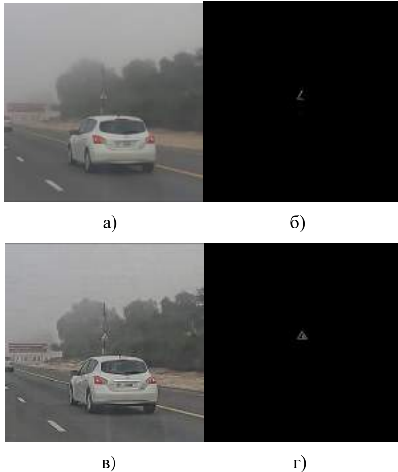
Рисунок 4.7 - Сегментація зображення в умовах туману. а) Стандартне зображення; б) Сегментація стандартного зображення; в) Оброблене алгоритмом сталості кольору зображення; г) Сегментація обробленого зображення
