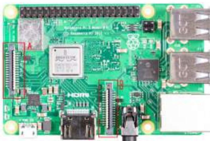
Рисунок 3.1 – Розміщення портів для підключення камери та дисплею на Raspberry Pi 3 Model B+
