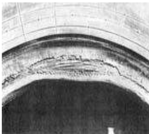
Рисунок 1.23 - Пошкодження борту через несправність обода
