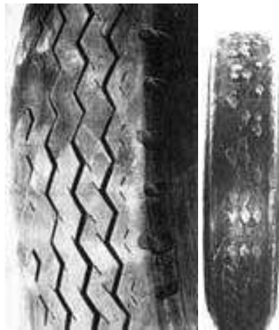
Рисунок 1.10 - Місцевий знос (плямистий знос)
