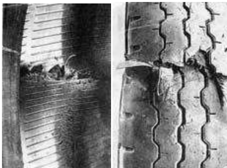
Рисунок 1.16 – Розрив протектора від удару
