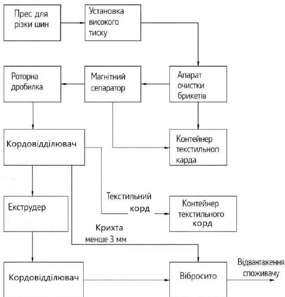
Рисунок 2.5 – Технологічна лінія бародеструкційного процесу переробки автомобільних шин
