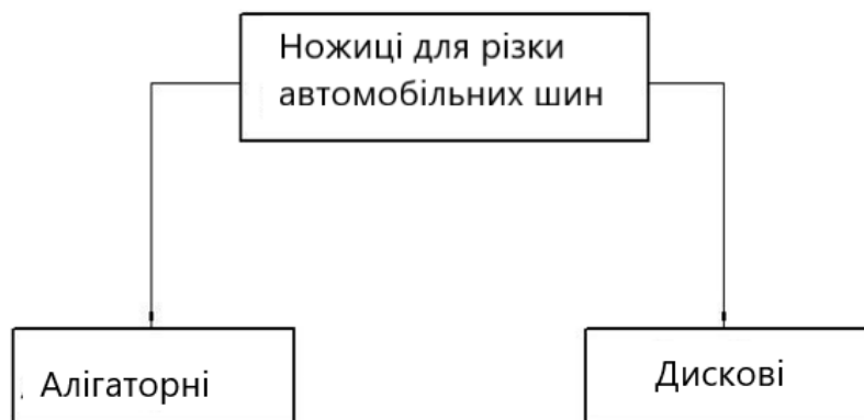
Рисунок 3.1 – Класифікація ножиць для різання шин
