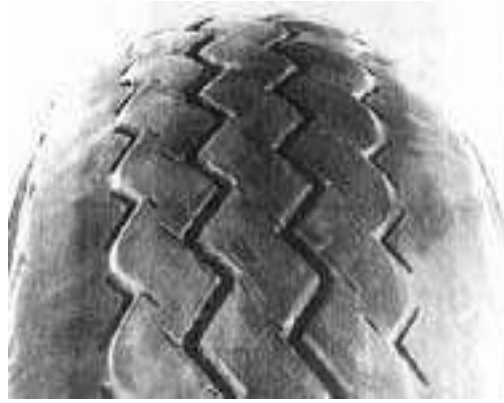
Рисунок 1.6 - Передчасне двостороннє зношування в плечовій зоні Передчасне зношування в центрі доріжки шини.
