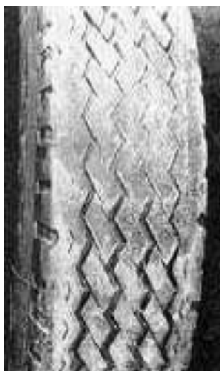
Рисунок 1.13 - Плямистий знос (місцевий знос)
