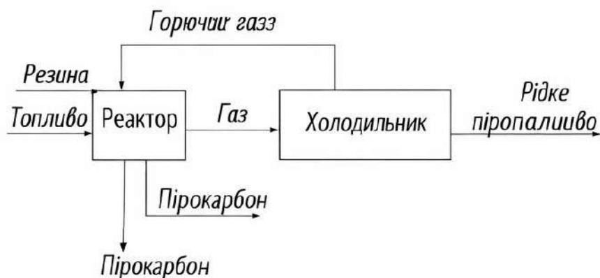
Рисунок 1.27 – Схема піролізу автомобільних шин
