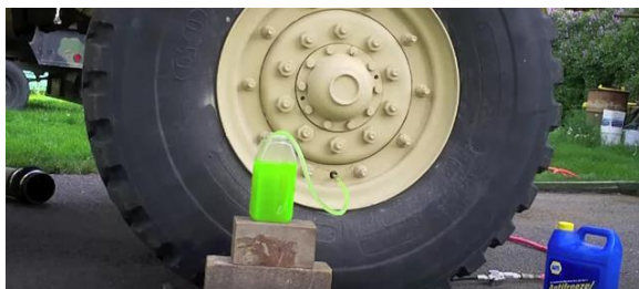
Рис. 3. Рідинне балансування коліс великих вантажних автомобілей
