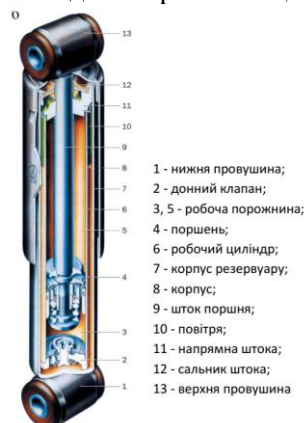
Рисунок 14 – Конструкція телескопічного двохтрубного амортизатора
