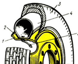
1 – обід колеса; 2 – ободова стрічка; 3 – покриття; 4 – камера; 5 – вентиль Рисунок 30 – Автомобільна шина у збірці з колесом
