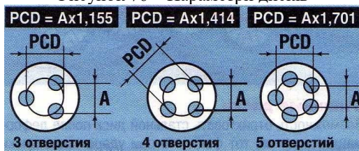
Рисунок 77 - Формула розрахунку PCD на відстані між центрами отворів (A)
