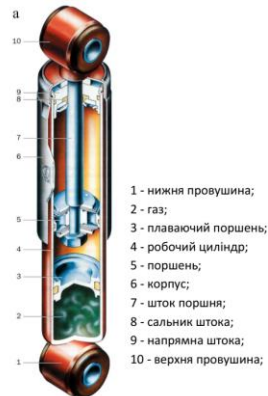
Рисунок 13 – Конструкція телескопічного однострубного амортизатора
