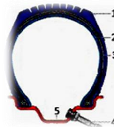
1 – покриття; 2 – герметизуючий повітронепроникний гумовий шар; 3 – каркас; 4 – вентиль колеса; 5 – обід
