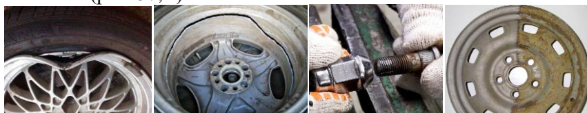
Рисунок 57 – Несправності автомобільних дисків
