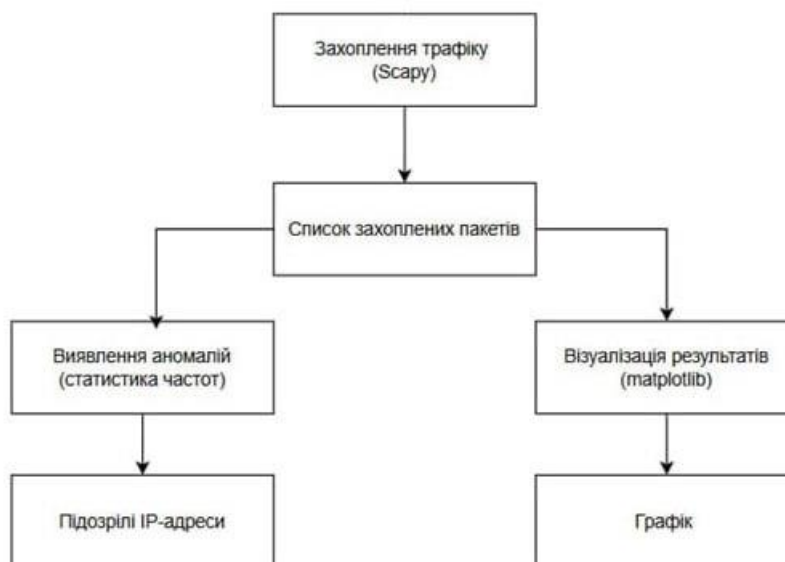
Рисунок 2.1 – Схема моделі виявлення прихованих атак у приватній мережі
